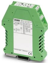
MCR-Strommessumformer, programmierbar und konfigurierbar, zur Messung von Gleich-, Wechsel- und verzerrten Strömen, mit Relais- und Transistor-Ausgang, Eingangsstrom 0 ... 0,2 A bis 0 ... 11 A, unkonfiguriert
