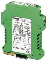
MCR-T-Modul, programmierbarer Temperaturmessumformer, konfiguriert, für Thermoelementsensoren und Widerstandsthermometer, in 2-, 3-, oder 4-Leitertechnik
