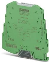
MCR-3-Wege-Trennverstärker, zur galvanischen Trennung von Analogsignalen, mit Schraubanschluss, Eingangssignal: 0 mA ... 20 mA, Ausgangssignal: 0 V ... 10 V
