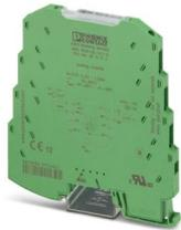
MCR-3-Wege-Trennverstärker, zur galvanischen Trennung von Analogsignalen, mit Schraubanschluss, Eingangssignal: 0 V ... 10 V, Ausgangssignal: 0 mA ... 20 mA
