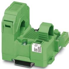
MCR-Strommessumformer, zur Messung von sinus- und nicht sinusförmigen Wechselströmen, Eingangsstrom 0...100 A, Loop-powered Ausgang mit 4...20 mA
