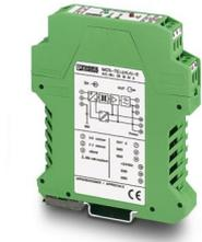
MCR-Temperaturmessumformer, für Thermoelemente Typ J, K Eingang: 0-400 °C, 0-800 °C, 0-1000 °C, 0-1200 °C, Eingang galvanisch getrennt, Ausgangssignal 0(4)...20 mA
