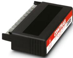
LSA-PLUS-Stecker (COMTRAB CT 10) mit Überspannungsgrob-/feinschutz, für 10 erdpotenzialfrei betriebene Signalkreise. Nennspannung: 24 V DC. Ausführung: 10 Doppeladern
