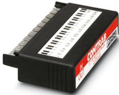
LSA-PLUS-Stecker (COMTRAB CT 10) mit Überspannungsgrob-/feinschutz für 18 Signalleitungen - GND und Grobschutz GND - PE. Nennspannung: 24 V DC. Ausführung: 10 Doppeladern
