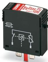
Überspannungsschutzstecker Typ 2 mit Hochleistungsvaristor für VAL-MS-Basiselement, thermisch überwacht, optische Defektmeldung. Ausführung: 60 V AC
