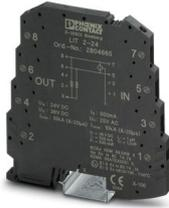
Überspannungsschutz im einteiligen 6,2 mm breiten Tragschienenmodul für zwei erdpotenzialfrei betriebene Signaladern. Geprüft nach Zündschutzarten in Ex-Bereichen: Ex ia IIC / Ex iaD.
