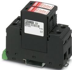
Universeller steckbarer Blitzstrom- / Überspannungsableiter auf Varistorbasis für -48VDC-Applikationen, in denen der Rückleiter (Pluspol) geerdet ist, ohne Risikobewertung für die Blitzschutzklassen III und IV, mit Fernmeldekontakt.
