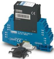
Überspannungsschutz, bestehend aus Schutzstecker und Basiselement, mit integrierter mehrstufiger Statusanzeige am Modul, für zwei 2-adrige erdpotenzialfrei betriebene Ex-i-Signalkreise. HART-fähig. In sicherheitsgerichteten Kreisen bis SIL 3 einsetzbar.
