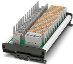
Geräteschutzschalter-Boards für zwölf thermomagnetische Schutzschalter CB TM1... mit Sammelfernmeldung, zentraler Einspeisung und Potenzialverteilung für bis zu fünf Verbraucher pro Kanal.
