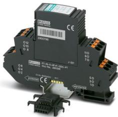
Überspannungsschutz, bestehend aus Schutzstecker und Basiselement, mit integrierter mehrstufiger Statusanzeige am Modul für fünf Signaladern. Für HF-Anwendungen und Telekommunikationsschnittstellen ohne Speisespannung (bis zu 90 MBit/s). In sicherheitsgerichteten Kreisen bis SIL 3 einsetzbar.
