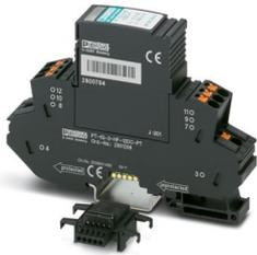
Überspannungsschutz, bestehend aus Schutzstecker und Basiselement, mit integrierter mehrstufiger Statusanzeige am Modul für drei Signaladern mit gemeinsamen Bezugspotenzial. Für HF-Anwendungen und Telekommunikationsschnittstellen ohne Speisespannung (bis zu 90 MBit/s). In sicherheitsgerichteten Kreisen bis SIL 3 einsetzbar.
