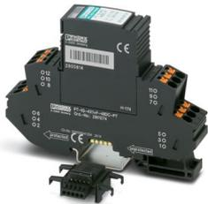
Überspannungsschutz, bestehend aus Schutzstecker und Basiselement, mit integrierter mehrstufiger Statusanzeige am Modul für vier Signaladern mit gemeinsamem Bezugspotenzial. Indirekte Erdung über Gasableiter. In sicherheitsgerichteten Kreisen bis SIL 3 einsetzbar.
