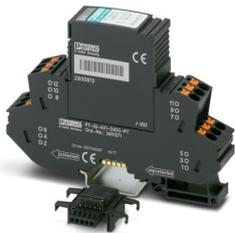
Überspannungsschutz, bestehend aus Schutzstecker und Basiselement, mit integrierter mehrstufiger Statusanzeige am Modul für vier Signaladern mit gemeinsamem Bezugspotenzial. In sicherheitsgerichteten Kreisen bis SIL 3 einsetzbar.
