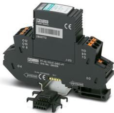
Überspannungsschutz, bestehend aus Schutzstecker und Basiselement, mit integrierter mehrstufiger Statusanzeige am Modul für einen 2-adrigen erdpotenzialfrei betriebenen Signalkreis. Indirekte Erdung über Gasableiter. In sicherheitsgerichteten Kreisen bis SIL 3 einsetzbar.
