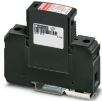
Universeller steckbarer Blitzstrom- / Überspannungsableiter auf Varistorbasis für 1-phasige Stromversorgungsnetze mit gemeinsamem N und PE (2-Leitersystem: L1, PEN).
