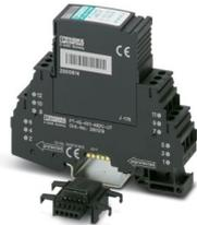
Überspannungsschutz, bestehend aus Schutzstecker und Basiselement, mit integrierter mehrstufiger Statusanzeige am Modul für vier Signaladern mit gemeinsamem Bezugspotenzial. In sicherheitsgerichteten Kreisen bis SIL 3 einsetzbar.
