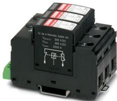
Blitzstrom- / Überspannungsableiter für 2-polige isolierte und geerdete PV-Gleichspannungssysteme 600 V DC, für Tragschienenmontage, 3-poliges Basiselement mit Fernmeldekontakt, drei steckbare temperaturüberwachte Schutzmodule, Statusmeldung an jedem Stecker.
