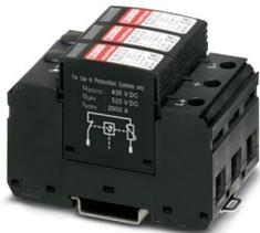
Blitzstrom- / Überspannungsableiter für 2-polige isolierte und geerdete PV-Gleichspannungssysteme 1000 V DC, für Tragschienenmontage, 3-poliges Basiselement, drei steckbare temperaturüberwachte Schutzelemente, Statusmeldung an jedem Stecker.
