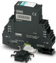
Überspannungsschutz, bestehend aus Schutzstecker und Basiselement, mit integrierter mehrstufiger Statusanzeige am Modul, für zwei 2-adrige erdpotenzialfrei betriebene Signalkreise, HART-fähig. In sicherheitsgerichteten Kreisen bis SIL 3 einsetzbar.
