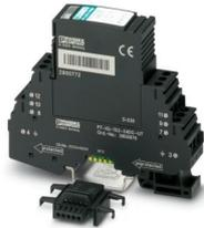
Überspannungsschutz, bestehend aus Schutzstecker und Basiselement, mit integrierter mehrstufiger Statusanzeige am Modul, für einen 2-adrigen erdpotenzialfrei betriebenen Signalkreis, HART-fähig. In sicherheitsgerichteten Kreisen bis SIL 3 einsetzbar.
