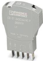
Elektronischer Geräteschutzschalter, 1-polig, aktive Strombegrenzung, 1 Öffnerkontakt, Stecker für Basiselement.
