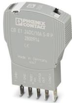
Elektronischer Geräteschutzschalter, 1-polig, aktive Strombegrenzung, Statusausgang und Reseteingang, Stecker für Basiselement.
