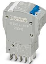
Thermomagnetischer Geräteschutzschalter, 2-polig, Auslösekennlinie M1 (mittelträge), 2 Wechslerkontakte, Stecker für Basiselement.
