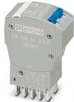
Thermomagnetischer Geräteschutzschalter, 2-polig, Auslösekennlinie SFB, 2 Wechslerkontakte, Stecker für Basiselement.
