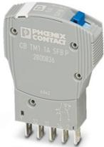
Thermomagnetischer Geräteschutzschalter, 1-polig, Auslösekennlinie SFB, 1 Wechslerkontakt, Stecker für Basiselement.
