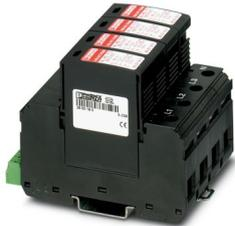
Steckbarer Blitzstromableiter auf Varistorbasis für 3-phasige TN-S Stromversorgungsnetze mit separatem N und PE (5-Leitersystem: L1, L2, L3, N, PE), für die Blitzschutzklassen III und IV, mit Fernmeldekontakt.
