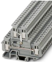
Minidurchgangsklemme, Der max. Strom wird durch die Diode bestimmt. Eingebaut: Diode 1N 4007, Sperrspannung: 1300 V, Dauergrenzstrom: 0,5 A., mit integrierter Diode, Nennspannung: 500 V, Nennstrom: 0,5 A, 1. und 2. Etage, Anschlussart: Schraubanschluss, Bemessungsquerschnitt: 2,5 mm<sup>2</sup>, Querschnitt: 0,2 mm<sup>2</sup> - 4 mm<sup>2</sup>, Montage: NS 15, NS 35/7,5, NS 35/15, Farbe: grau
