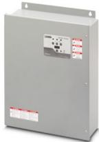
Überspannungsschutzgerät für Wye-Konfigurationen mit 120/208 V AC als Geräteschutz für den Einspeisepunkt. Schützt über alle Phasen und Richtungen hinweg. Das NEMA-Gehäuse bietet einen Monitor mit Überspannungszähler, Status-LEDs und akustischem Alarm mit Fernmeldekontakt. Hybrid Sine Wave Tracking bietet einen 180 kA-Überspannungsschutz.
