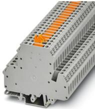
Messertrennklemme, mit Prüfbuchsen-schrauben zur Aufnahme von Prüfsteckern, Nennspannung: 400 V, Nennstrom: 26 A, 1. Etage, Anschlussart: Schraubanschluss, Bemessungsquerschnitt: 4 mm<sup>2</sup>, Querschnitt: 0,2 mm<sup>2</sup> - 4 mm<sup>2</sup>, 2. Etage, Anschlussart: Schraubanschluss, Bemessungsquerschnitt: 4 mm<sup>2</sup>, Querschnitt: 0,2 mm<sup>2</sup> - 4 mm<sup>2</sup>, Montage: NS 35/7,5, NS 35/15, NS 32, Farbe: grau
