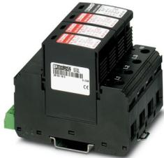
Universeller steckbarer Blitzstrom- / Überspannungsableiter auf Varistorbasis für 3-phasige Stromversorgungsnetze mit separatem N und PE (5-Leitersystem: L1, L2, L3, N, PE), für die Blitzschutzklassen III und IV, mit Fernmeldekontakt.
