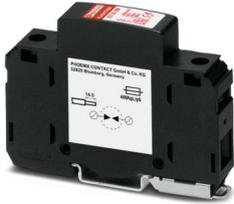
Typ 1 / Class I / B-Ableiter (Blitzstromableiter) mit gekapselter Arc-Chopping-Funkenstrecke, 1-kanalig. Gehäusebreite: 17,5 mm (1TE)
