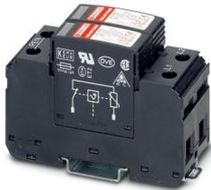
2-poliger schienenmontabler Überspannungsableiter für 2+0-Schaltung, thermisch/dynamisch überwacht, optische Defektmeldung, Ableiter-Bemessungsspannung: 275 V AC.
