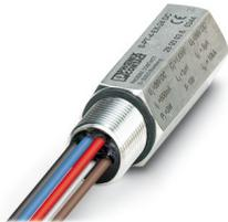
Zweistufiger Überspannungsschutz für drei oder vier Signale erdpotenzialfrei betriebener Signalkreise im Anschraubmodul der Schutzart IP67 für Sensorköpfe, Anschluss M20 x 1,5. Geprüft nach Zündschutzarten in Ex-Bereichen Ex d / Ex tD / Ex ia IIC / Ex iaD. Ist geeignet zum Einsatz im Feldbus-System nach dem FISCO Konzept, HART-fähig. In sicherheitsgerichteten Kreisen bis SIL 3 einsetzbar.
