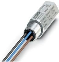
Überspannungsschutz für einen erdpotenzialfrei betriebenen Signalkreis im Anschraubmodul der Schutzart IP67 für Sensorköpfe, Anschluss M20 x 1,5. Geprüft nach Zündschutzarten in Ex-Bereichen Ex d / Ex tD / Ex ia IIC / Ex iaD. Ist geeignet zum Einsatz im Feldbussystem nach dem FISCO Konzept, HART-fähig. In sicherheitsgerichteten Kreisen bis SIL 3 einsetzbar.
