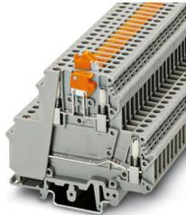
Messertrennklemme, mit Prüfbuchschrauben zur Aufnahme von Prüfsteckern, Nennspannung: 400 V, Nennstrom: 26 A, 1. und 2. Etage, Anschlussart: Schraubanschluss, Bemessungsquerschnitt: 4 mm<sup>2</sup>, Querschnitt: 0,2 mm<sup>2</sup> - 4 mm<sup>2</sup>, 2. Etage, Anschlussart: Schraubanschluss, Bemessungsquerschnitt: 4 mm<sup>2</sup>, Querschnitt: 0,2 mm<sup>2</sup> - 4 mm<sup>2</sup>, Montage: NS 35/7,5, NS 35/15, NS 32, Farbe: grau
