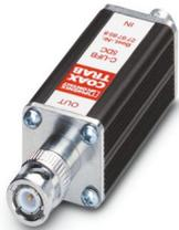
Zwischenstecker mit Überspannungsgrob- und -feinschutz für koaxiale Signalschnittstellen, Signalspannung 5 V. Anschluss: BNC Buchse-Stecker
