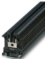
Reihenklemme mit Überspannungsfeinschutz zwischen Klemmkörper und Tragschiene, Nennspannung: 12 V AC, Montage auf NS 32 oder NS 35/7,5, Klemmenbreite: 6,2 mm, Klemmenhöhe: 47 mm
