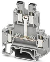
Doppelstockklemme, mit Potenzialverbinder, Nennspannung: 500 V, Nennstrom: 32 A, Anschlussart: Schraubanschluss, Bemessungsquerschnitt: 4 mm<sup>2</sup>, Querschnitt: 0,2 mm<sup>2</sup> - 4 mm<sup>2</sup>, Montageart: NS 35/7,5, NS 35/15, NS 32, Farbe: grau
