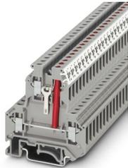
Bauelementreihenklemme, Nennspannung: 24 V, Nennstrom: 32 A, 1. Etage, Anschlussart: Schraubanschluss, Bemessungsquerschnitt: 4 mm<sup>2</sup>, Querschnitt: 0,2 mm<sup>2</sup> - 4 mm<sup>2</sup>, Montage: NS 35/7,5, NS 35/15, NS 32, Farbe: grau
