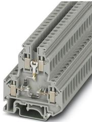
Bauelementreihenklemme, mit integrierter Diode, Nennstrom: 0,5 A, Anzahl der Anschlüsse: 4, Anschlussart: Schraubanschluss, Bemessungsquerschnitt: 4 mm<sup>2</sup>, 1. und 2. Etage, Querschnitt: 0,2 mm<sup>2</sup> - 4 mm<sup>2</sup>, Montageart: NS 35/7,5, NS 35/15, NS 32, Farbe: grau
