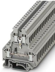
Bauelementreihenklemme, mit integrierter Diode, Nennstrom: 0,5 A, Anzahl der Anschlüsse: 4, Anschlussart: Schraubanschluss, Bemessungsquerschnitt: 4 mm<sup>2</sup>, 1. und 2. Etage, Querschnitt: 0,2 mm<sup>2</sup> - 4 mm<sup>2</sup>, Montageart: NS 35/7,5, NS 35/15, NS 32, Farbe: grau
