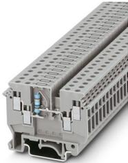
Bauelementreihenklemme, Anzahl der Anschlüsse: 4, Anschlussart: Schraubanschluss, Bemessungsquerschnitt: 4 mm<sup>2</sup>, 1. Etage, Querschnitt: 0,2 mm<sup>2</sup> - 6 mm<sup>2</sup>, Montageart: NS 35/7,5, NS 35/15, NS 32, Farbe: grau
