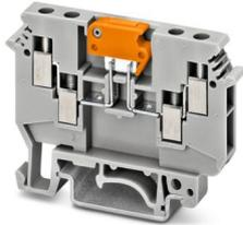
Messertrennklemme, mit Prüfbuchenschrauben zur Aufnahme von Prüfsteckern, Nennspannung: 630 V, Nennstrom: 16 A, Anschlussart: Schraubanschluss, Bemessungsquerschnitt: 4 mm<sup>2</sup>, Querschnitt: 0,2 mm<sup>2</sup> - 6 mm<sup>2</sup>, Montage: NS 35/7,5, NS 35/15, NS 32, Farbe: grau
