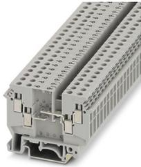
Durchgangsklemme, zum Einbau von selbst wählbaren Bauelementen, Nennspannung: 630 V, Nennstrom: 32 A, 1. Etage, Anschlussart: Schraubanschluss, Bemessungsquerschnitt: 4 mm<sup>2</sup>, Querschnitt: 0,2 mm<sup>2</sup> - 6 mm<sup>2</sup>, Montage: NS 35/7,5, NS 35/15, NS 32, Farbe: grau
