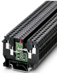
Bauelementreihenklemme, Nennspannung: 500 V, Nennstrom: 0,5 A, 1. Etage, Anschlussart: Schraubanschluss, Bemessungsquerschnitt: 4 mm<sup>2</sup>, Querschnitt: 0,2 mm<sup>2</sup> - 6 mm<sup>2</sup>, Montage: NS 35/7,5, NS 35/15, NS 32, Farbe: schwarz
