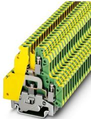
Schutzleiter-Reihenklemme, Anzahl der Anschlüsse: 4, Anschlussart: Schraubanschluss, 1. und 2. Etage, Querschnitt: 0,2 mm<sup>2</sup> - 4 mm<sup>2</sup>, Befestigungsart: PE-Fuß mit Befestigungsschraube, M3, Montageart: NS 35/7,5, NS 35/15, NS 32, Farbe: grün-gelb
